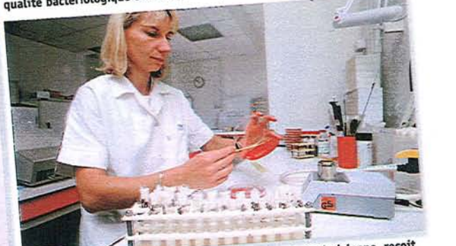
9 Dans le labo de bactériologie, Isabelle Goy, la technicienne, reçoit les tubes d'échantillon. Elle dépose sur la gélose nutritive d'une boîte de Petri 10 microlitres de lait. Cette gélose permettra de faire "pousser" les germes, qui seront identifiés et comptés...
