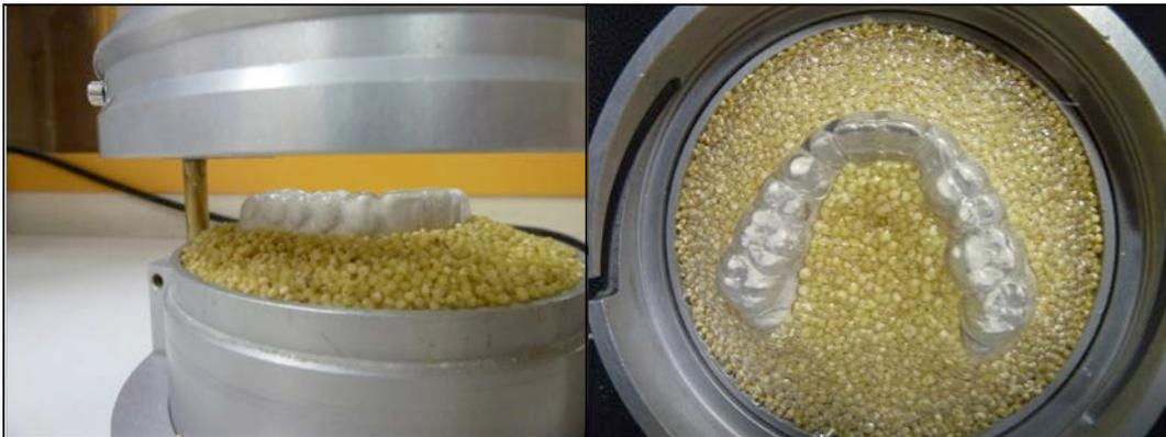
Figure 64 : Mise en place de la première couche d'EVA sur le modèle en plâtre (Filippi, 2011).
