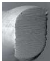
Figure 25 : section en "S" du Reciproc® VDW
