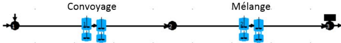
Figure 34 : Modèle de granulateur par extrusion
