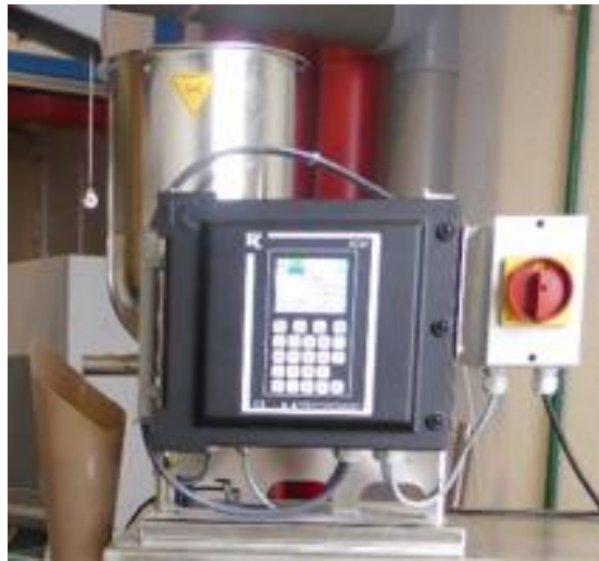
Figure 28 : Doseur de poudre K-TRON SFS-24/6 pour la granulation par extrusion
