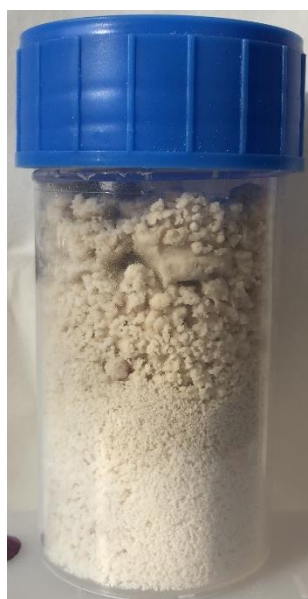
Figure 43 : Grains produits par extrusion suite à un blocage de l'alimentation en liquide de mouillage
