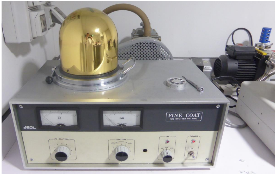
Figure 40 : Métallisation d'échantillons à observer au Microscope Electronique à Balayage
