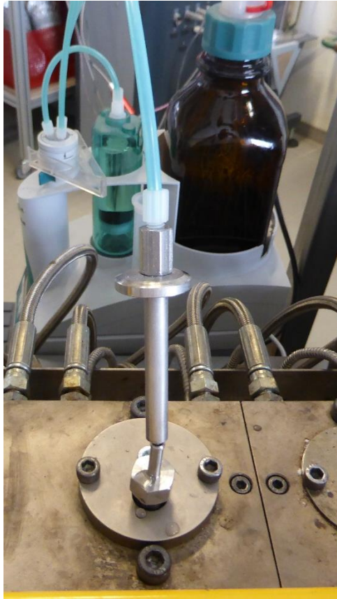
Figure 32 : Alimentation en liquide de mouillage lors d'une opération de granulation par extrusion
