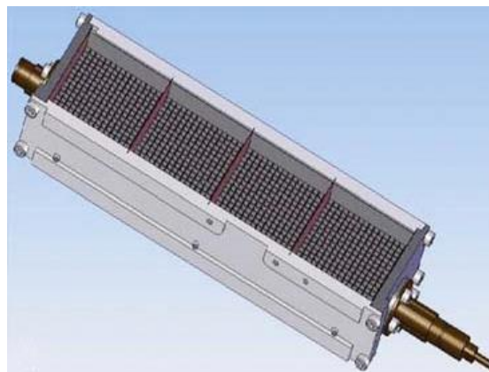
Figure 6 : Présentation des 9 colonnes détectrices de la caméra D.SPECT (en haut) et représentation schématique d'une colonne de détection (en bas).
