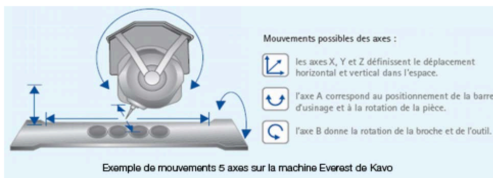
Figure 57: exemple de mouvement sur 5 axes sur la machine Everest de Kavo (source : CNIFPD-UNPPD, 2009)
