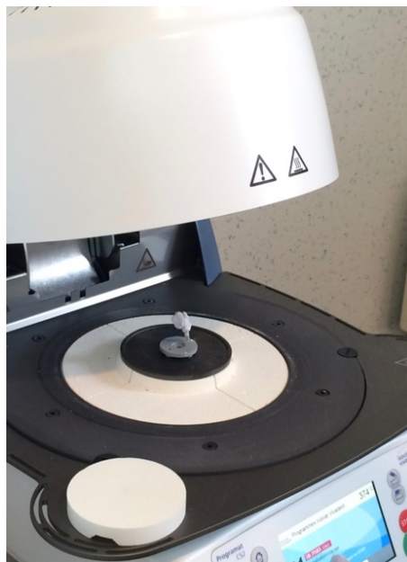
Figure 94: mise au four à céramique de la restauration (source: Dr P. Corne)
