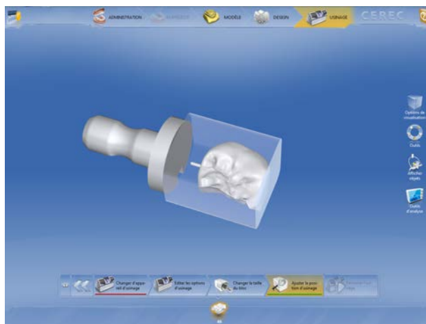
Figure 53: capture d'écran de la fenêtre usinage (source: P. Corne)
