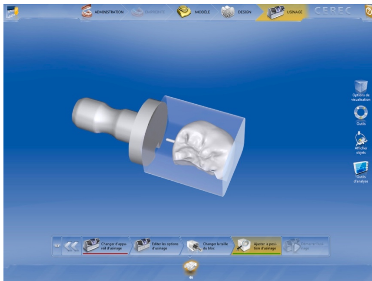
Figure 115: placement de la restauration et de la tige d'usinage dans le bloc virtuel (source: Dr P. Corne)
