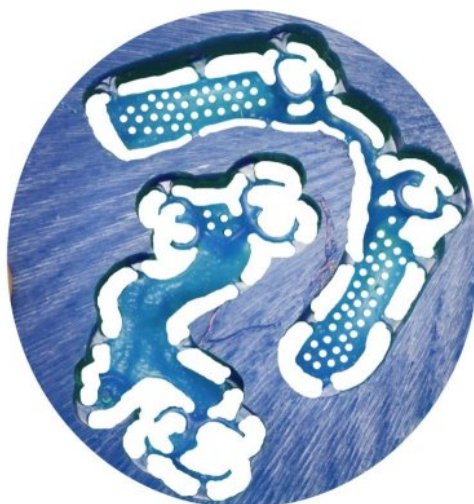
Figure 56 : Disque après usinage, Système Digistell (digilea.com)
