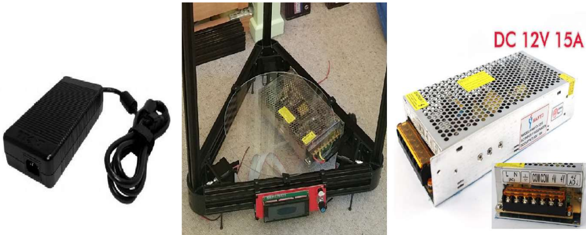
Figure 95 : Alimentation externe à gauche, alimentation externe intégrée dans la base d'une imprimante 3D delta au milieu, alimentation externe à droite (Source : jacobspart ; collection personnelle ; my.pricelist)
