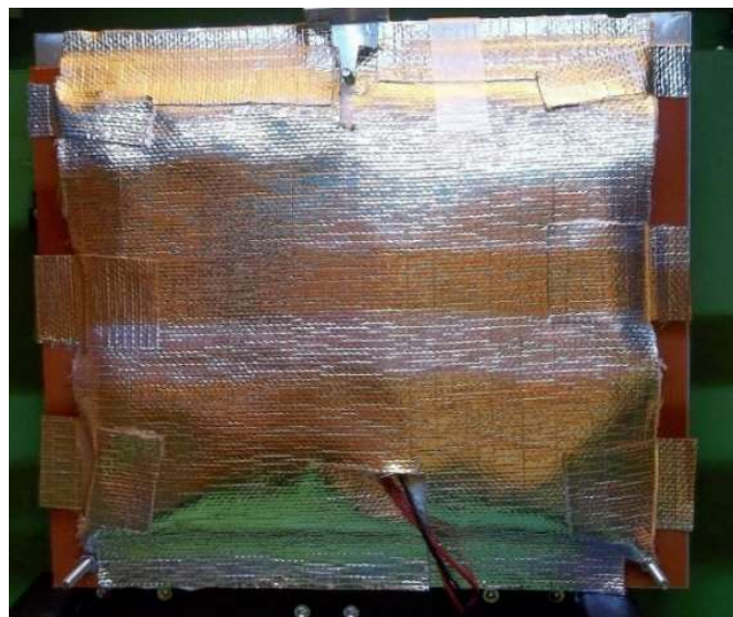
Figure 128 : Isolation du lit chauffant avec du scotch aluminium (Source : craftunique)
