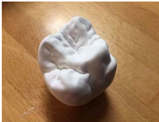
Figure 174 : Couronne de molaire réalisée par impression 3D FDM d'un fichier 3D de la plateforme thingiverse (Source : thingiverse)
