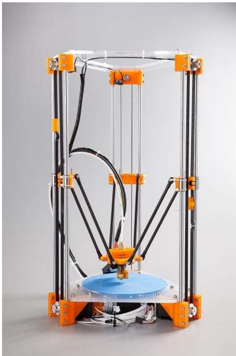
Figure 79 : Imprimante 3D FDM de type delta modèle Rostock mini (Source : reppap)
