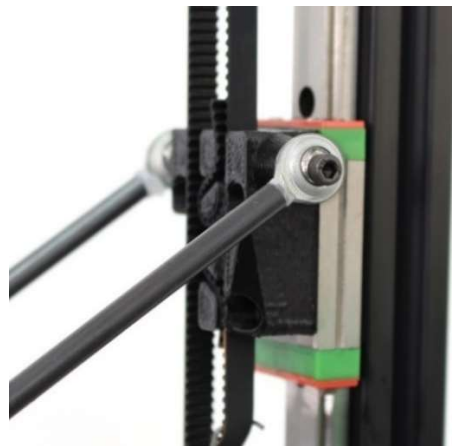
Figure 101 : Entraînement par courroie des chariots (Source : loneshopper)
