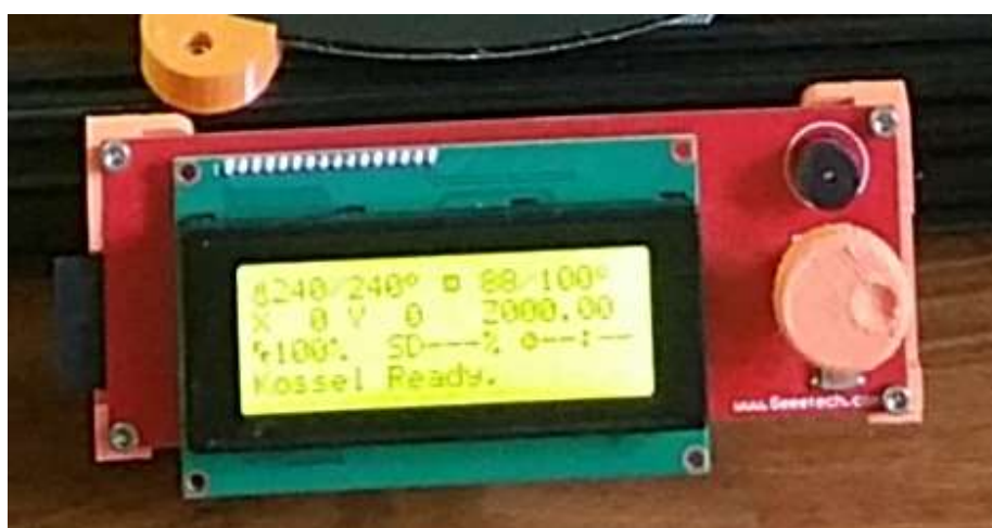
Figure 121 : Affichage des informations de température et positionnement sur un écran LCD 2004 (Source : photographie personnelle)
