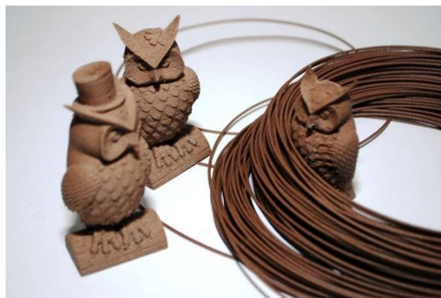
Figure 157 : Figurines imprimées en filament Laywood (Source : 3dprintingforbeginners)
