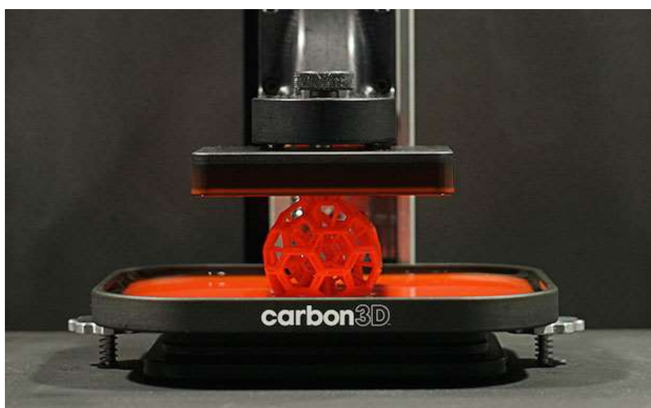
Figure 51 : Imprimante 3D de la marque Carbon 3D ® en action (Source : techcrunch)
