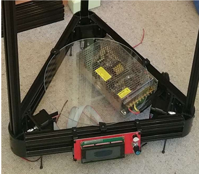
Figure 130 : Alimentation intégrée dans la base de l'imprimante (Source : photographie personnelle)
