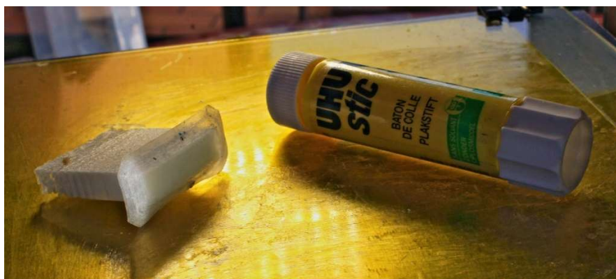
Figure 137 : Utilisation de colle en bâton UHU ® comme adhésif (Source : tridimake)
