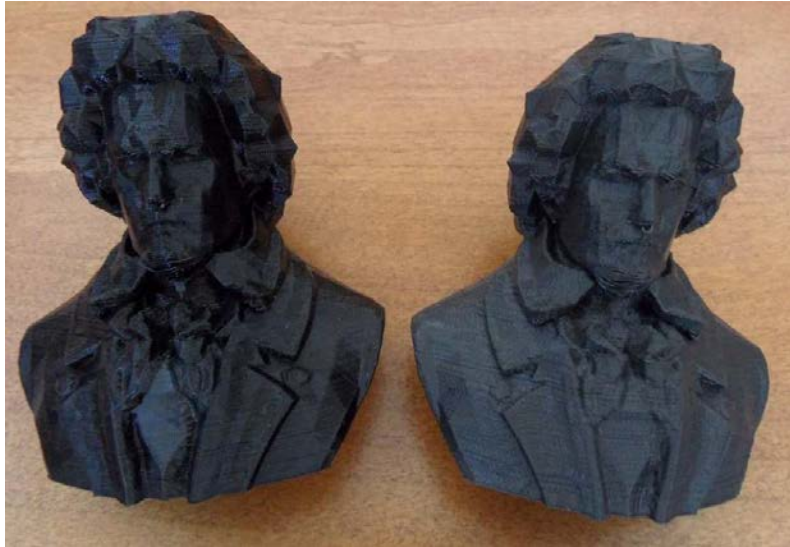
Figure 144 : Figurine imprimée en ABS à gauche versus figurine en PLA à droite (Source : nicklievendag)
