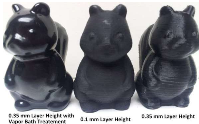
Figure 69 : Comparaison de l'état de surface de trois figurines imprimées par la technique FDM avec des réglages différents. De gauche à droite, couche de 0.35mm avec polissage à l'acétone, 0.1mm sans polissage, 0.35mm sans polissage (Source : 3ders)
