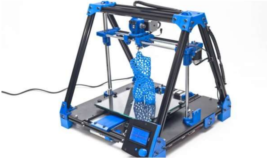
Figure 77 : Imprimante 3D à chariot élévateur de type Mendel Max de chez Bcn3d ® (Source : bcn3dtechnologies )
