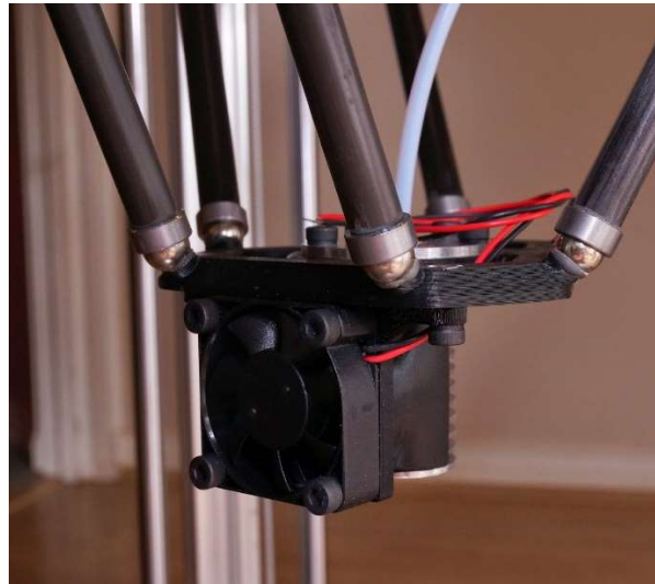
Figure 133 : Tête d'impression d'un imprimante 3D delta avec aimants (Source : d3delta3d)
