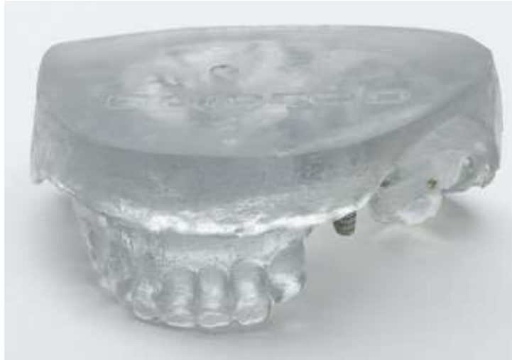
Figure 152 : Modèle d'étude imprimé en polymère liquide MED610 (Source : dponthenet)
