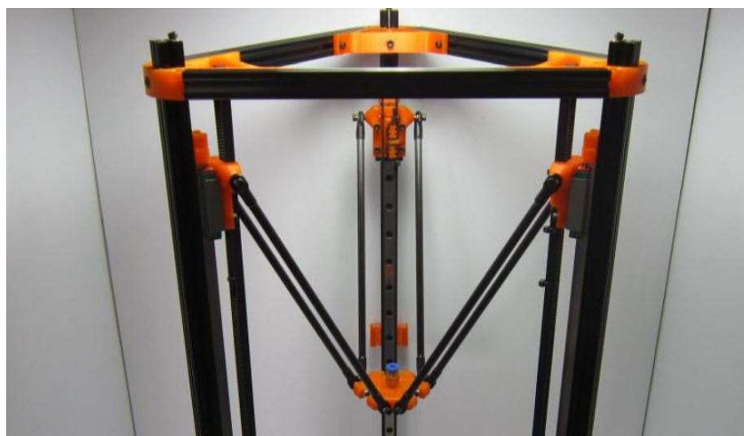
Figure 110 : Assemblage de l'araignée sur la structure du châssis (Source : blomker industries)
