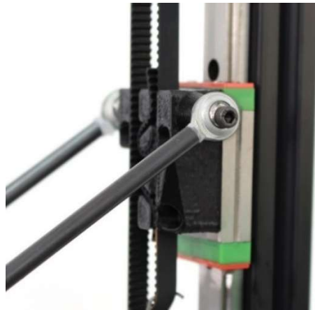
Figure 101 : Entraînement par courroie des chariots (Source : loneshopper)
