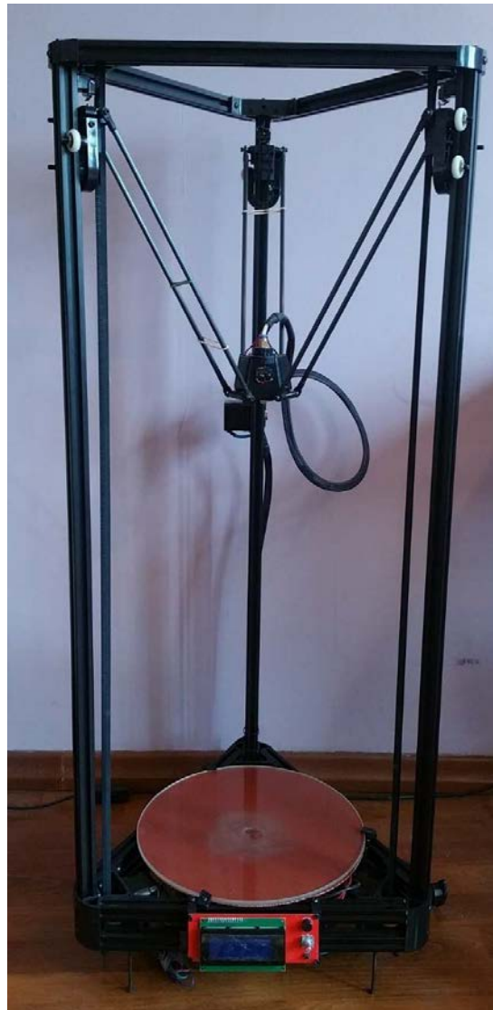
Figure 140 : Deuxième prototype d'imprimante 3D delta (Source : photographie personnelle)
