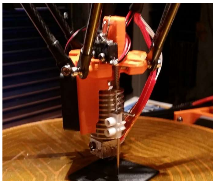
Figure 107 : Tête d'impression et système d'auto calibration (Source : photo personnelle)
