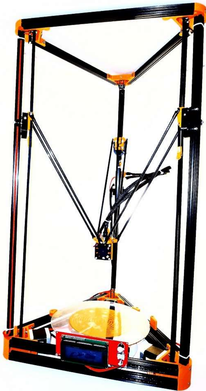
Figure 115 : Imprimante 3D delta réalisée pour la thèse terminée (Source : photographie personnelle)
