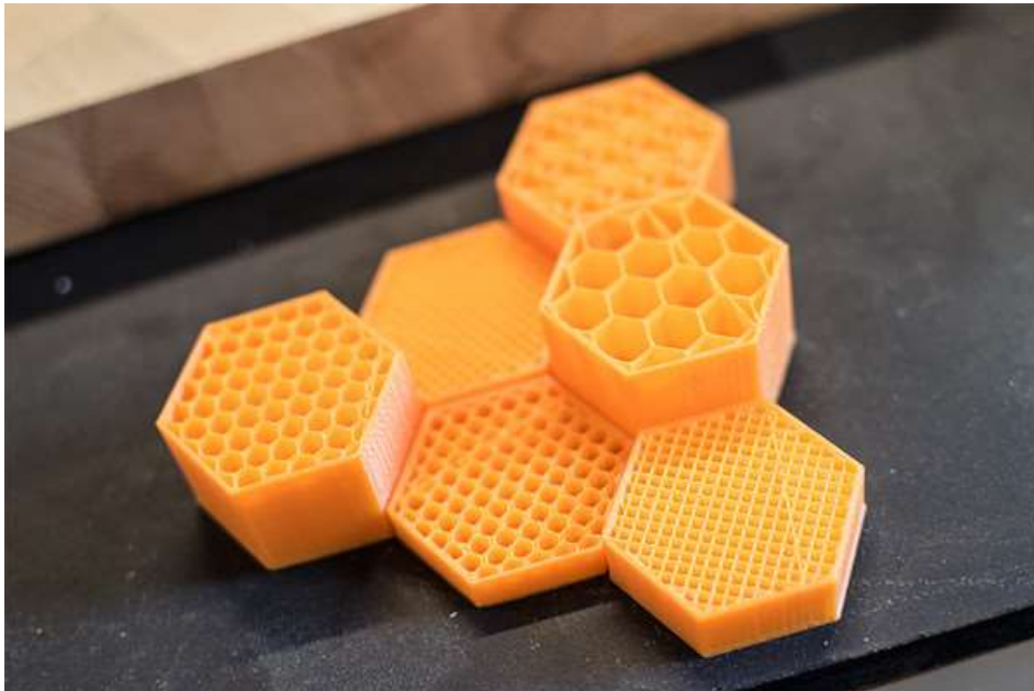
Figure 162 : Structures internes en nid d'abeilles de plus ou moins grandes densités (Source : 3ders)
