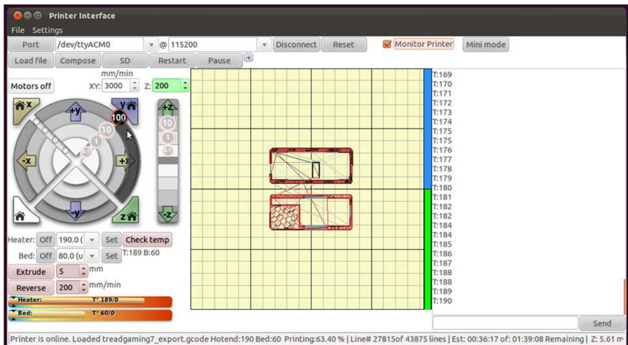
Figure 166 : Interface de pilotage d'imprimante 3D pronterface avec fichier stl chargé en vue de l'impression (Source : treadgaming)
