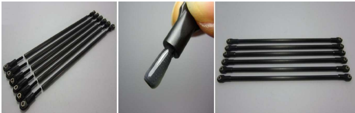
Figure 109 : Assemblage des traxxas et des rod end en carbone à la colle epoxy (Source : blomker industries)
