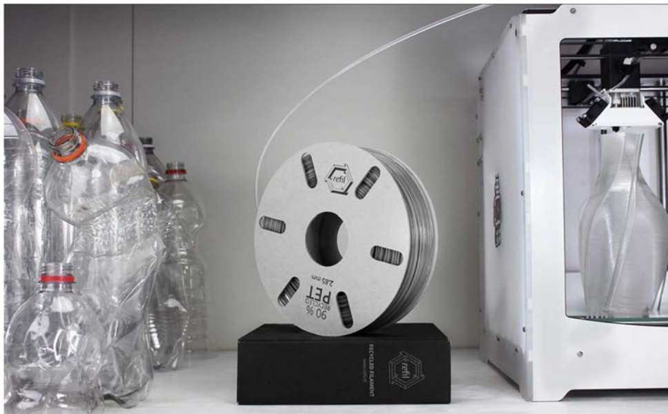
Figure 146 : Impression en filament de PET (Source : 3dprinterchat)
