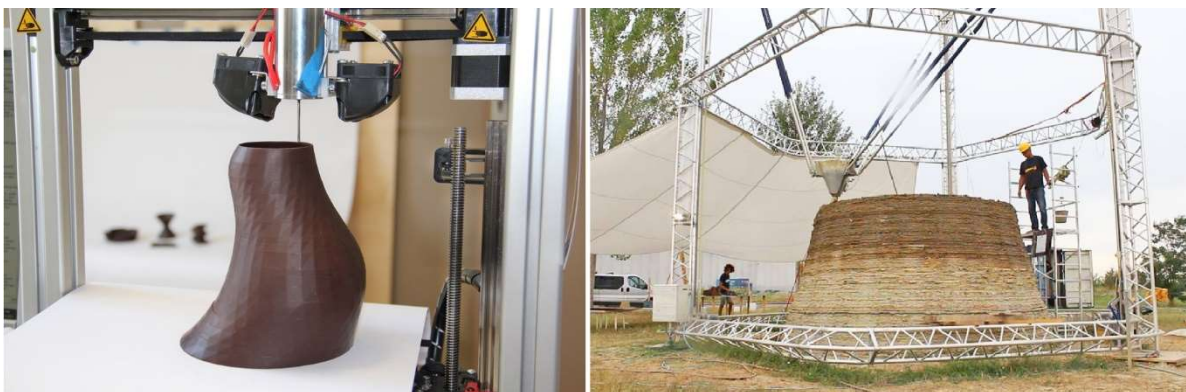
Figure 70 : Impression de chocolat à gauche, impression d'une habitation à droite (Source : npr et inhabitat)
