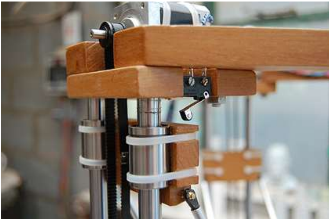
Figure 86 : Endstop mécanique en position ouvert en bout d'axe z d'une imprimante 3D delta (Source : keep-art)
