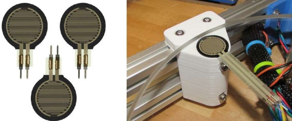
Figure 94 : Capteur de pression FSR à gauche, placé sous le plateau d'impression à droite (Source : tridprinting et thingiverse)
