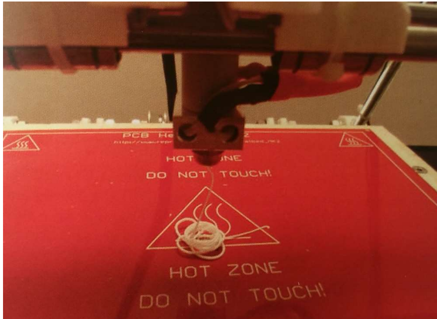
Figure 167 : Extrusion du filament préparatoire (Source : L'impression 3D 2 ème édition)
