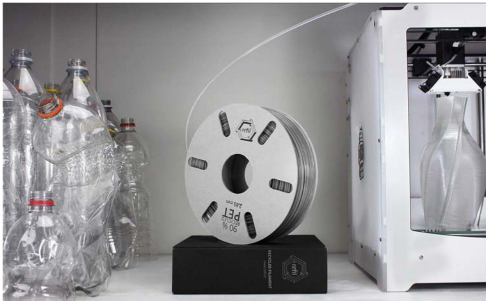
Figure 146 : Impression en filament de PET (Source : 3dprinterchat)
