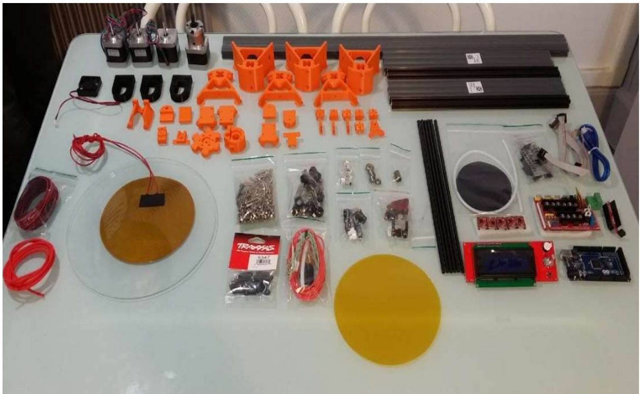
Figure 104 : Ensemble des pièces du kit de l'imprimante 3d delta (Source : photo personnelle)
