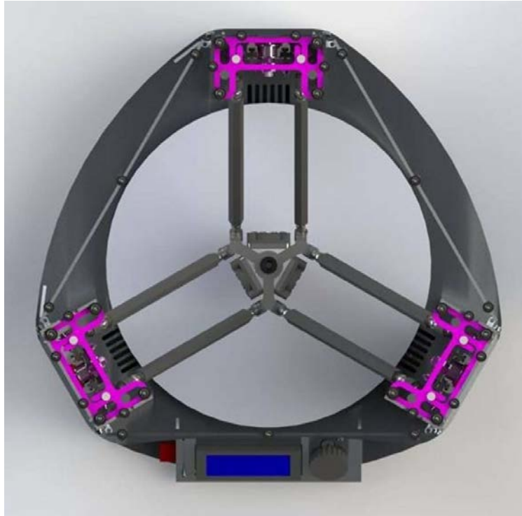
Figure 102 : Vue du dessus de l'araignée d'une imprimante 3d delta (Source : 3dprintingindustry)
