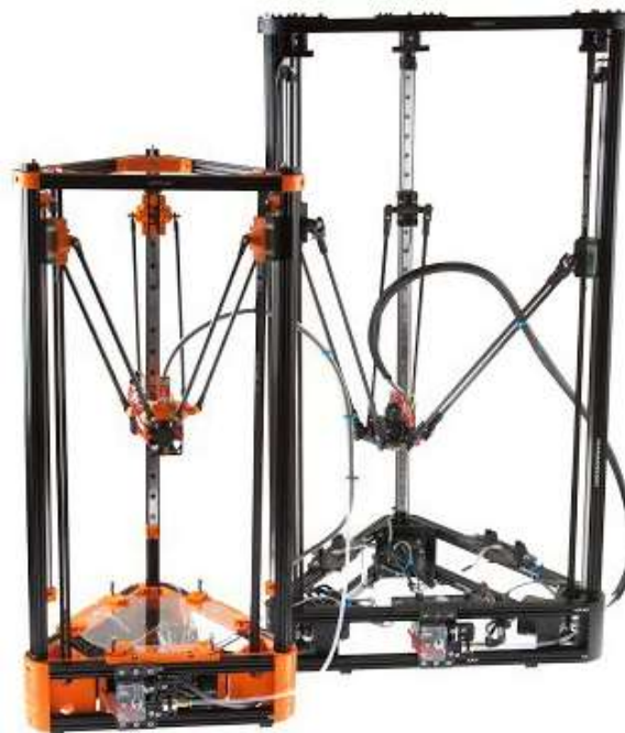
Figure 97 : Imprimante 3d delta Kossel mini à gauche, Kossel XL à droite (Source : build3dprinter)
