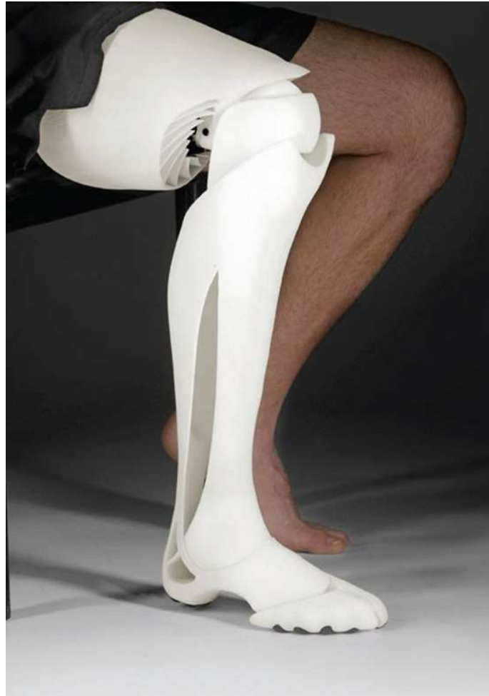
Figure 56 : Prothèse de jambe complète réalisée à l'aide d'une imprimante 3D SLS (Source : makepartsfast)
