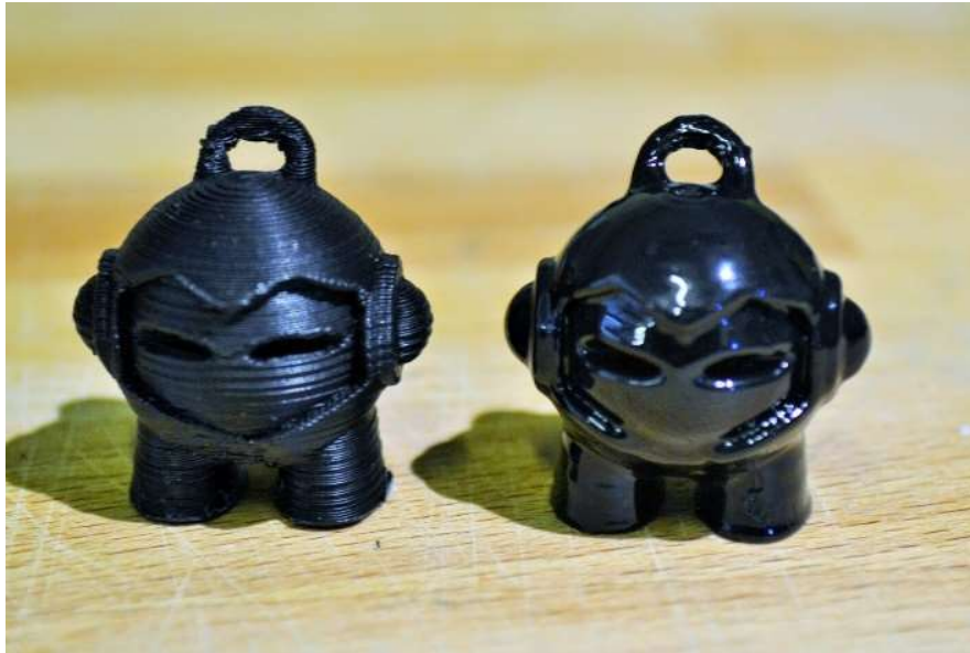
Figure 172 : Figurine en ABS sans traitement à gauche et après un bain de vapeur à l'acétone à droite (Source : pinshape)
