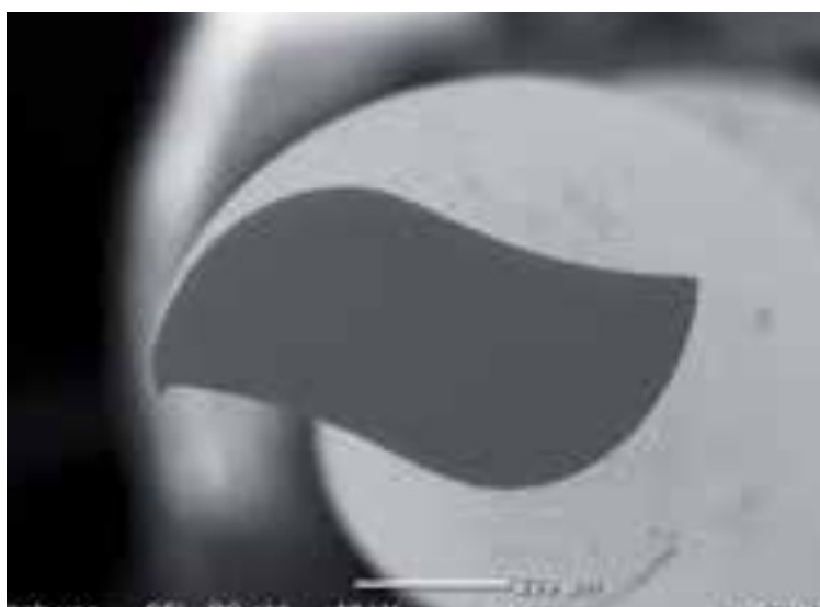
Figure 20 : Image en microscopie à balayage électronique représentant une coupe en section transversale du F360® (Komet®).
