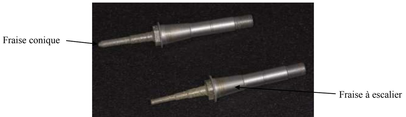
*Figure 40: Fraises de l'usineuse ivoclar Mc inlab xl*
