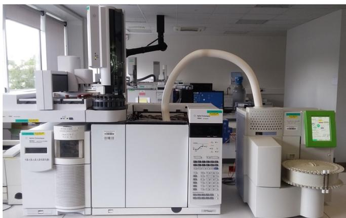
Figure 25 : Thermodésorbeur couplé CPG-SM - LERES Rennes
