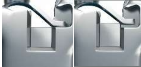
Figure 22: système interactif: pour une section en dessous de .017x.025 inch, puis pour une section supérieure, elle devient active l'attache est passive, source : ( https://www.dentsply.com )
