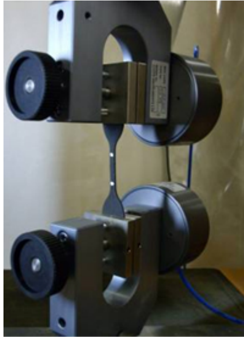
Figure 2 : machine de traction réalisant un test de traction sur une éprouvette
