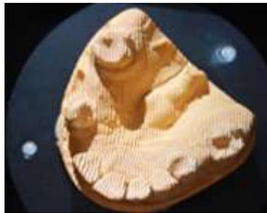
*Figure 52 : numérisation d'un modèle en plâtre par lumière blanche structuré
