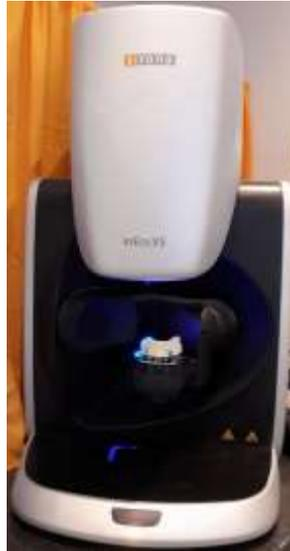
*Figure 96 : mise en place du support sur le bras rotor du scanner 3D inEos X5
