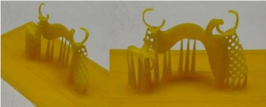
*Figure 123 : obtention du châssis fabriqué verticalement avec ses supports
