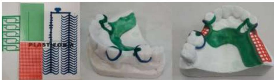
*Figure 84 : fabrication de la maquette du châssis à l'aide des préformes en cire
