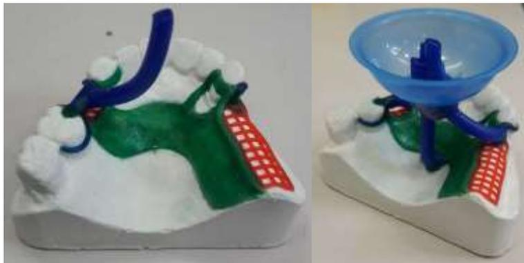
*Figure 86 : mise en place des tiges de coulées (source : document personnel)*
