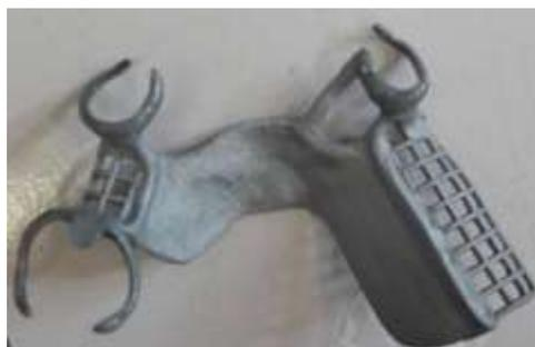
*Figure 91 : isolation des crochets avant passage au bain électrolytique (source : document personnel)*
