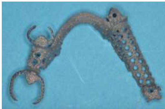
*Figure 45 : un problème de la micro-fusion est l'aspect rugueux de la surface
