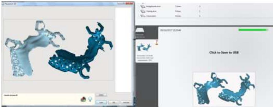
*Figure 114 : positionnement des deux maquettes sur la plaque de fabrication
