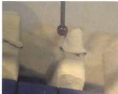
*Figure 19 : numérisation par contact : micro-palpeur Procera (source : Deschamp, Fages et Duret, 2016)*
