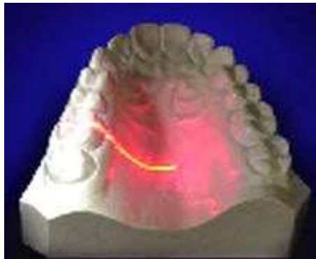
Figure 23 : numérisation par triangulation laser (Source : Cnifpd-Unppd, 2009)
