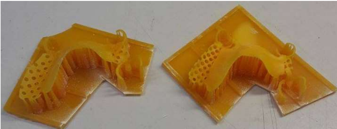
Figure 119 : séparation des deux maquettes (source : document personnel)
