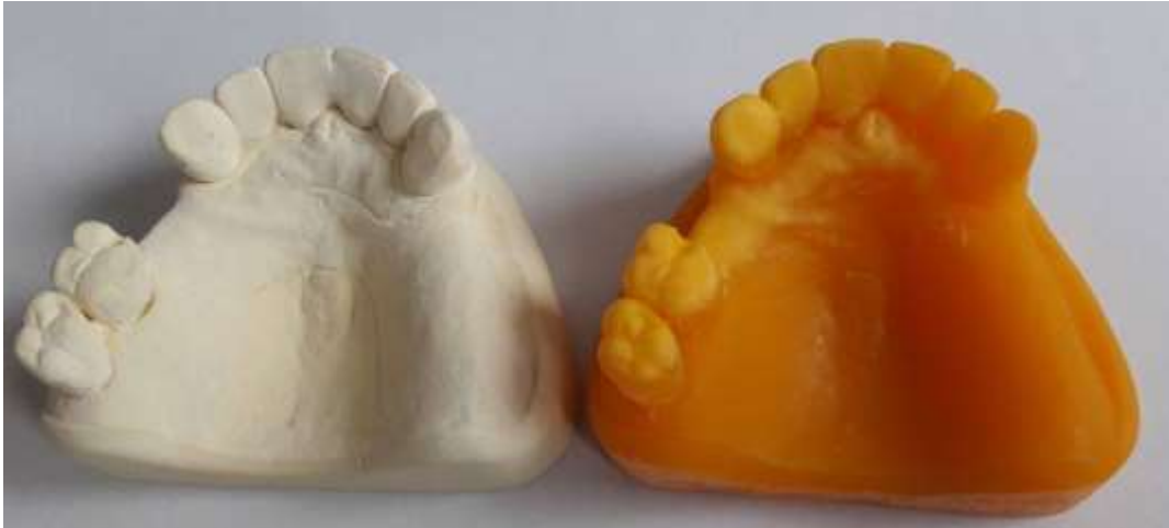
Figure 125 : visualisation du modèle de travail en plâtre et celui imprimé par stéréolithographie (source : document personnel)
