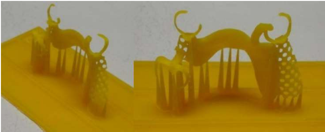
Figure 123 : obtention du châssis fabriqué verticalement avec ses supports (source : document personnel)
