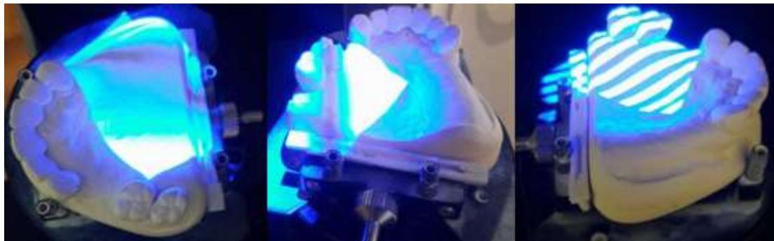
Figure 97 : numérisation en cours par lumière structurée (source : document personnel)
