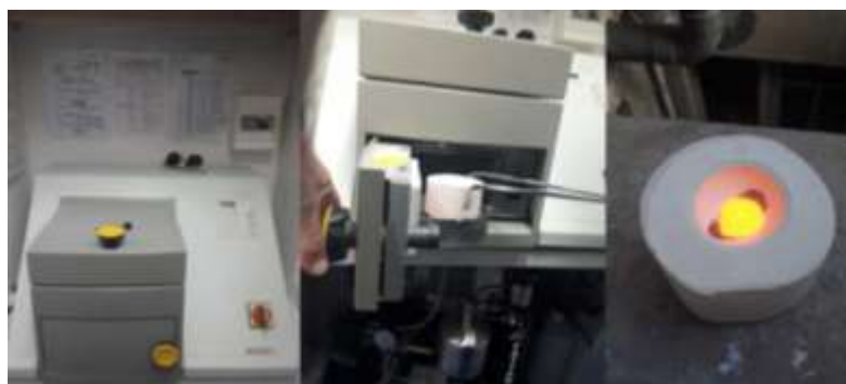
Figure 89 : coulée du châssis par aspiration, et refroidissement du cylindre (source : document personnel)
