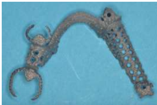
Figure 45 : un problème de la micro-fusion est l'aspect rugueux de la surface (source : Ohkubu et coll, 2017)
