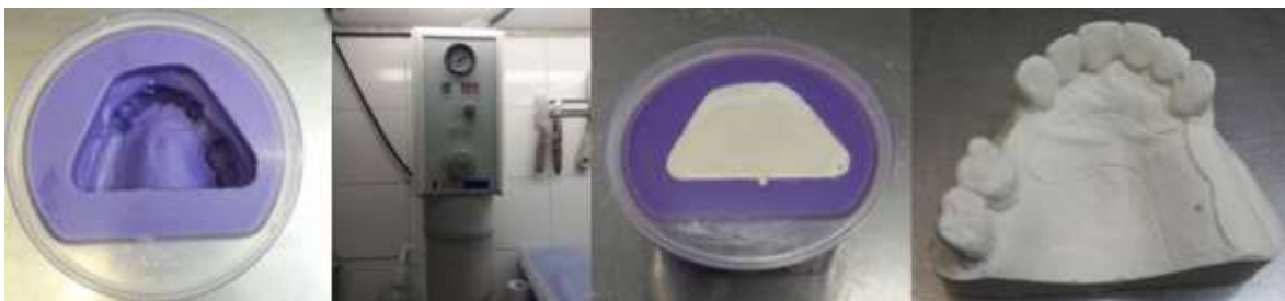
Figure 83 : coulée de la duplication en matériau de revêtement (source : document personnel)
