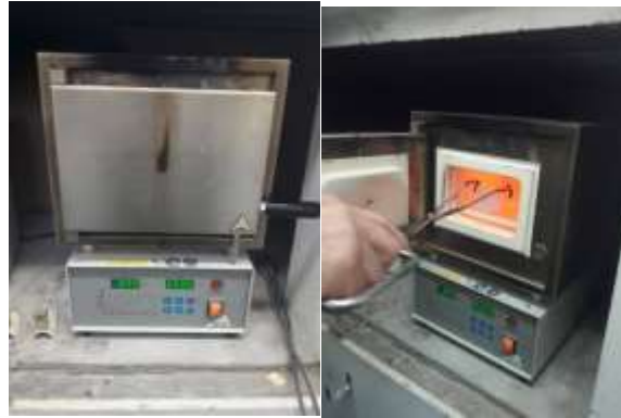
Figure 88 : suppression de la maquette calcinable au four (source : document personnel)
