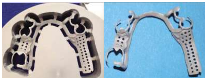
Figure 129 : châssis usiné et découpé dans un disque en PEEK (source : Picart et coll, 2016)
