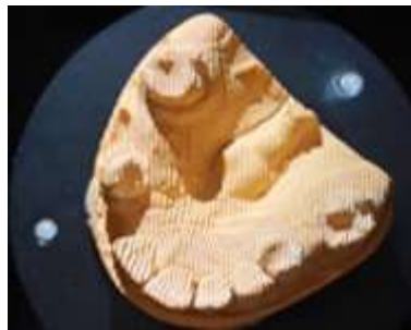
Figure 52 : numérisation d'un modèle en plâtre par lumière blanche structurée (source : Digilea)
