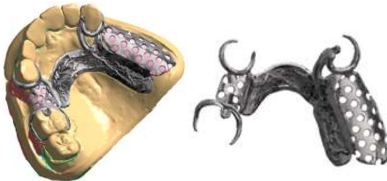
Figure 65 : visualisation du châssis terminé sur le modèle numérique avant fabrication (source : document personnel)
