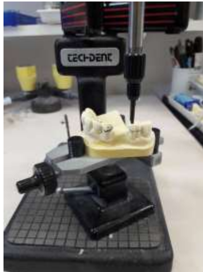
Figure 80 : choix de l'axe d'insertion et tracé de la ligne de plus grand contour (source : document personnel)
