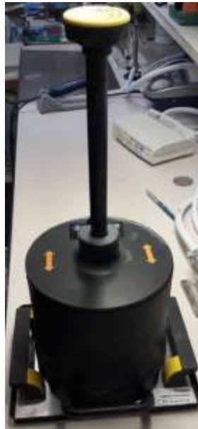
Figure 117 : visualisation de la cartouche contenant les objets imprimés (source : document personnel)
