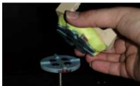
Figure 49 : le modèle de travail stabilisé sur une plaquette, allant être positionné sur la rotule de la chambre du scanner (source : Taddei, Etienne et Baixe, 2012)
