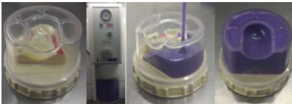
Figure 82 : obtention d'un silicone de duplication (source : document personnel)
