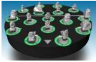
Figure 28 : numérisation simultanée de 16 préparations avec le scanner DW de dental Wings (Source : Cnifpd-Unppd, 2009)
