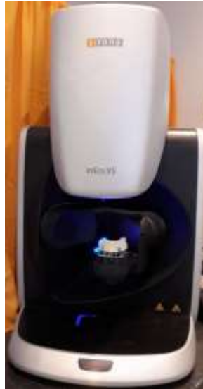
Figure 96 : mise en place du support sur le bras rotor du scanner 3D inEos X5 (source : document personnel)
