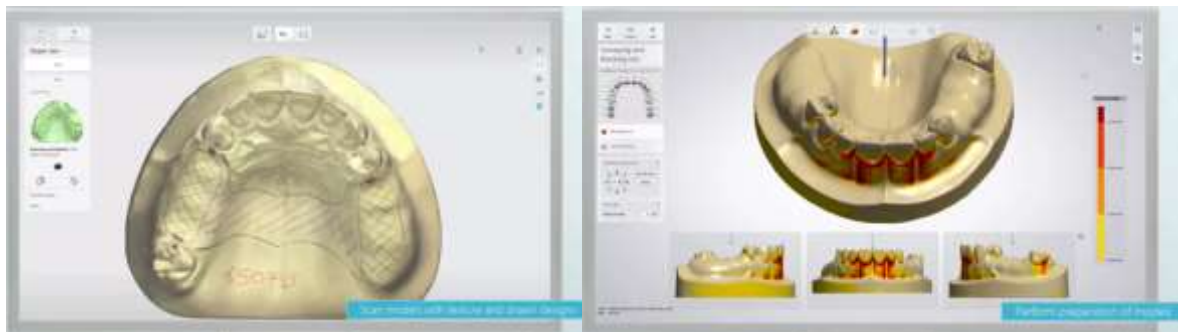
Figure 70 : visualisation du modèle numérique et des zones de contres dépouilles selon l'axe d'insertion de la prothèse choisi (Source : 3Shape)
