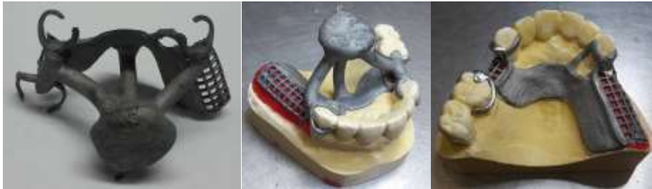
Figure 90 : sablage, suppression des tiges de coulées, dégrossissage et ajustage sur le modèle de travail (source : document personnel)
