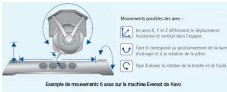
Figure 47 : mouvements possibles des axes d'une usineuse (Source : Cnifpd-Unppd, 2009)
