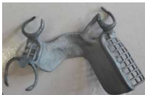
Figure 91 : isolation des crochets avant passage au bain électrolytique (source : document personnel)
