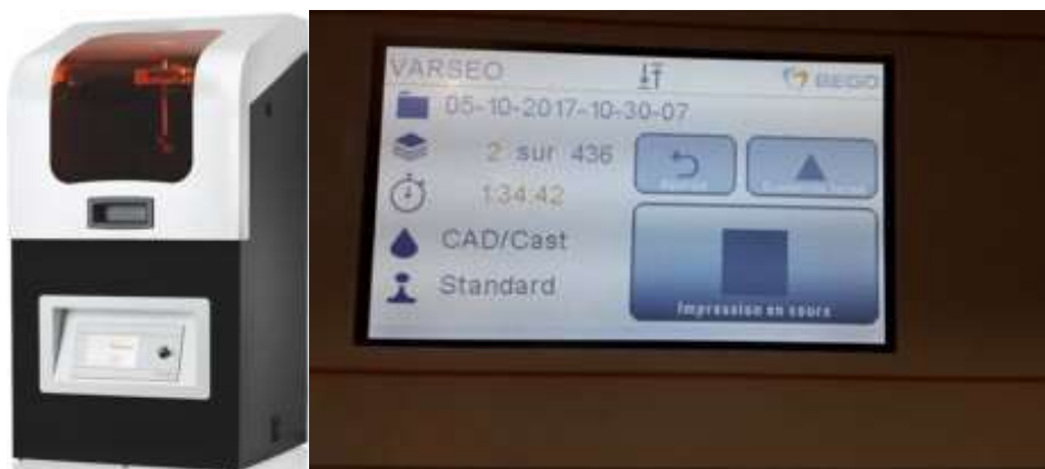
Figure 116 : machine-outil Bego Varseo et visualisation de l'écran de contrôle de fabrication (source : document personnel)
