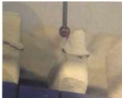
Figure 19 : numérisation par contact : micro-palpeur Procera (source : Deschamp, Fages et Duret, 2016)
