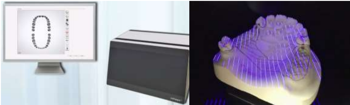
Figure 69 : système d'acquisition numérique de 3Shape ® et numérisation du modèle de travail (Source : 3Shape)
