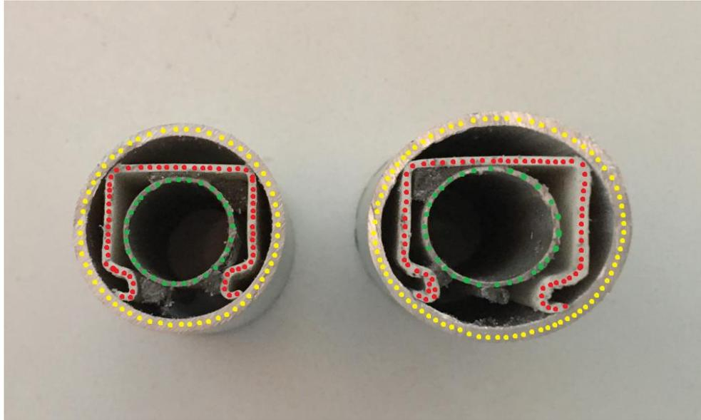
**Figure 56** : Expérience des cylindres : vue aérienne des coupes des cylindres. Les deux coupes sont différentes. Le recalage de celles-ci est impossible
