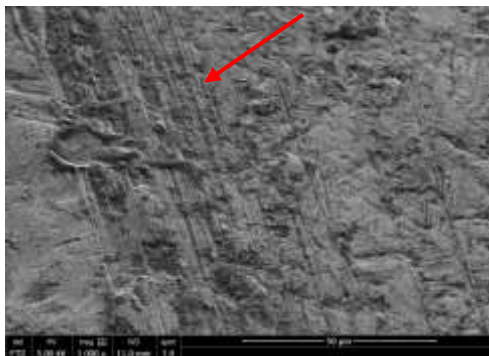
Figure 60 : Cliché réalisé en Microscopie Electronique à Balayage du méplat du pilier 1 après le dixième serrage.
