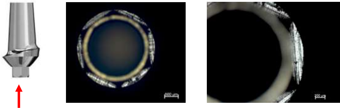
Figure 28 : Pilier implantaire (partie inferieure) observé au Microscope Optique respectivement au grossissement x2,5 lentille x1 et au grossissement x5 lentille x1 (pilier 2)
