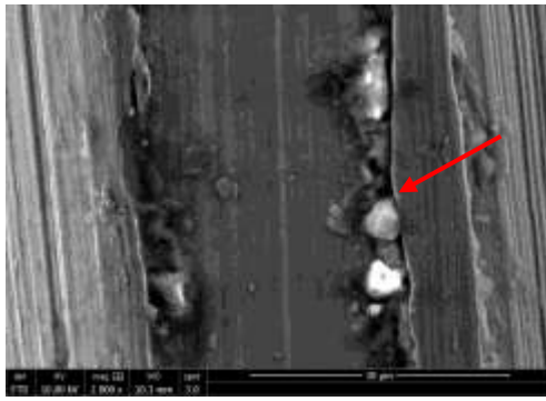
Figure 61 : Cliché réalisé en Microscopie Electronique à Balayage du sommet du pas de vis de la vis du pilier 1 après le deuxième serrage.
