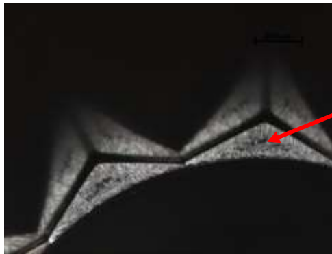
Figure 46 : Cliché réalisé en Microscopie Optique de la connexion implantaire de l'implant 2 au grossissement X10 après 9 serrages.
