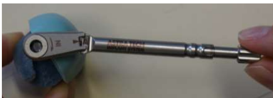
Figure 26 : Pilier serré, clé en position de débrayage.
