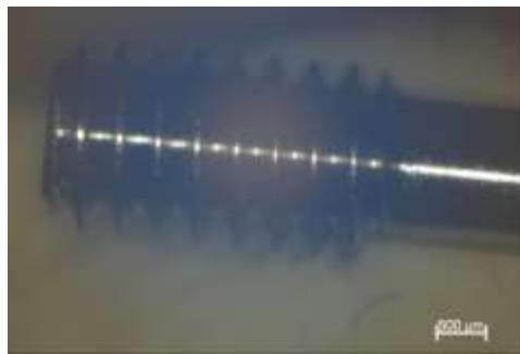
Figure 29 : Observation au Microscope Optique de la vis de pilier implantaire (spires) grossissement x2,5 lentille x1 (vis pilier 1)
