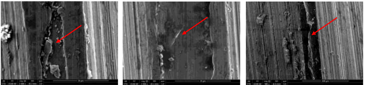
Figure 62 : Clichés réalisés en Microscopie Electronique à Balayage respectivement d'un sommet de la vis du pilier 2 après le deuxième serrage puis du pilier 2 après le quatrième serrage et enfin du pilier 1 après le huitième serrage.
