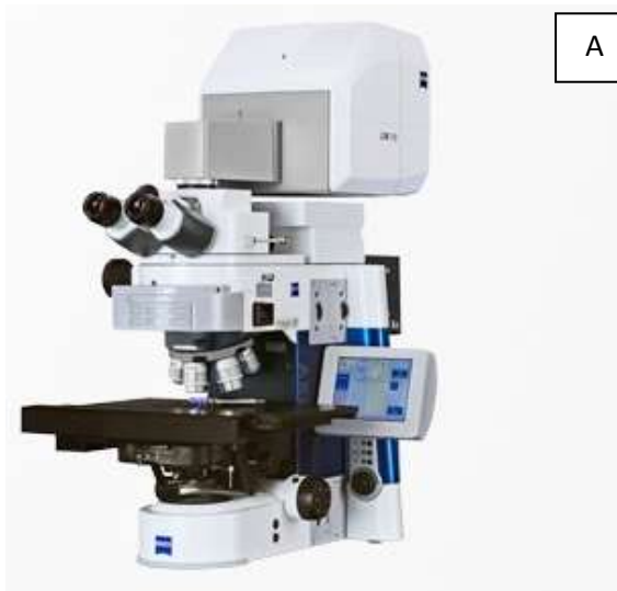
Figure 38 : A : Microscope Optique Confocal LSM 700 ( http://www.zeiss.fr/microscopy ) ; B : Nanotom® de la société Phoenix X-Ray™ pour des analyses en tomographie 3D ( www.gemeasurement.com )
