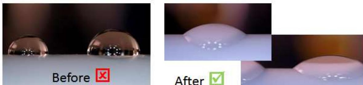
Figure 12 : modification du potentiel hydrophile du PEEK après traitement au plasma (<http://www.intrfacetech.com/atmospheric-plasma-treatment-for-medical-device-applications/>, 2016)
