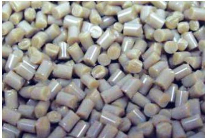
Figure 3 : avant d'être mis en forme, le PEEK se présente sous forme de granulés (Kemish D, 1995)
