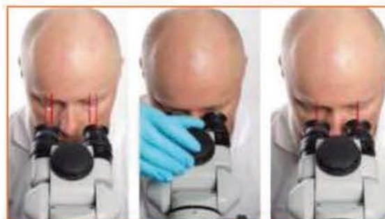
Figure 68 : Réglage manuel de la distance interoculaire (Source : brochure Zeiss®).
