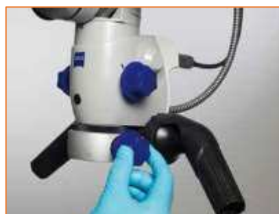
Figure 70 : Ajustement fin et manuel de la focale après positionnement correct du microscope (Source : brochure Zeiss®).
