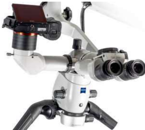
Figure 27 : Microscope OPMI pico de la marque ZEISS® équipé d'un diviseur optique simple auquel est fixé un raccordement pour le positionnement d'un appareil photo numérique (Source : brochure ZEISS®).
