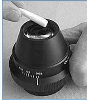
Figure 81 : Utilisation de l'écouvillon ou de la lingette optique sur les surfaces à nettoyer (Source : www.allichénologie.fr ).
