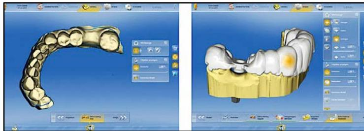
Figure 25 : modèle virtuel (à gauche) et conception 3D du guide chirurgical (à droite) (source : Bindl, 2015)
