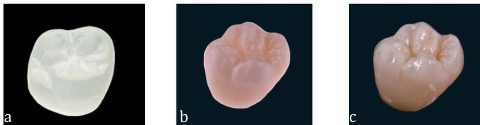
Figures 86 : coloration de la zircone : 86a : couronne avant coloration ; 86b : couronne après coloration ; 86c : couronne après maquillage et glaçage (source : Zirkozahn World Wide. La zircone « Prettau ». Technique de mise en œuvre et de coloration de la zircone « Prettau », 2017)
