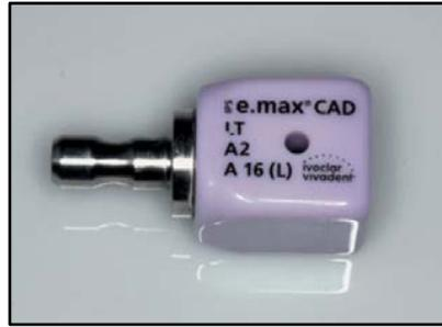
Figure 76 : bloc de matériau IPS e.max® CAD A2 LT pré-percé (source : Mahl et coll., 2014)
