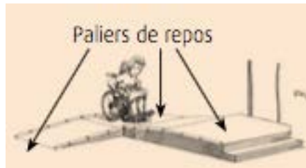
Figure 23 : Illustration du palier de repos (Sources : Ministères des affaires sociales et de la santé et Ministère de l'écologie du développement durable et de l'énergie « Les locaux des professionnels de santé : réussir l'accessibilité » (PDF) ).
