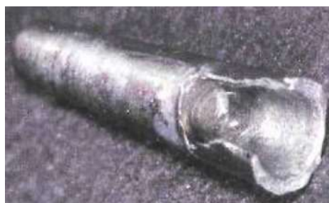
Figure 30: Tenon fraisé jusqu'à son délogement (Couvrechel et coll., 2011)
