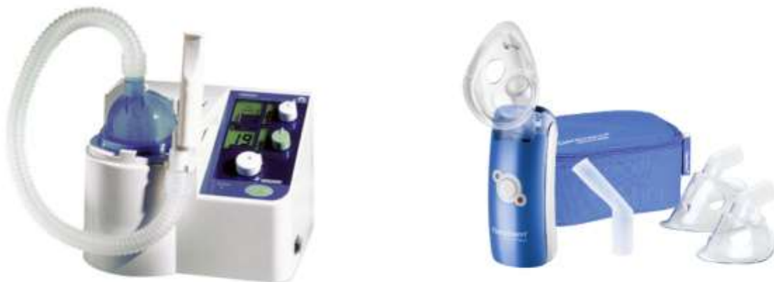
FIGURE 6: NÉBULISEUR FIXE AVEC EMBOUT BUCCAL (À GAUCHE) ET NÉBULISEUR PORTATIF AVEC MASQUE FACIAL (À DROITE) D'APRÈS [28-29].
