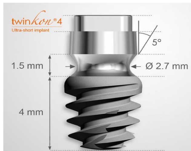
Figure 12 : Dimensions détaillées de l'implant Twinkon® 4 (source : © Global D. Twinkon® 4).
