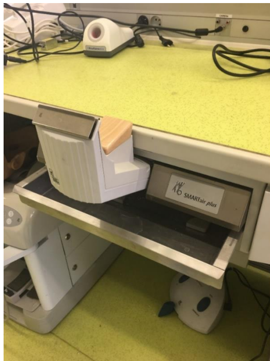
Figure 7 : le tiroir métallique et la cheville d'aspiration (source : document personnel)
