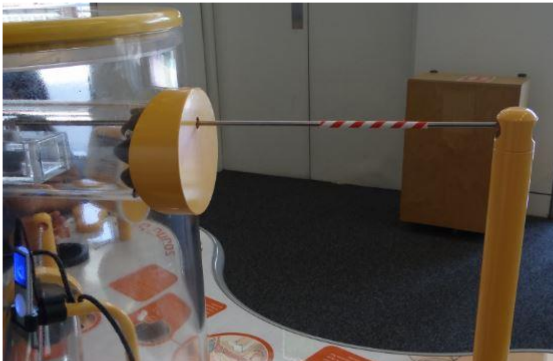
Image 14 : Présentation de la barre en métal, sortant du tube de verre, et de la surface à mordre avec sa paille à usage unique (photographie personnelle).
