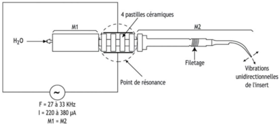
Figure 17 : Fonctionnement du détartreur piézoélectrique (source : Blanc, 2008).
