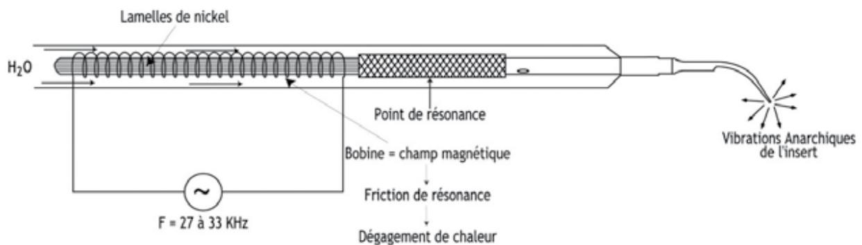
Figure 16 : Fonctionnement du détartreur piézomagnétique (source : Blanc, 2008).
