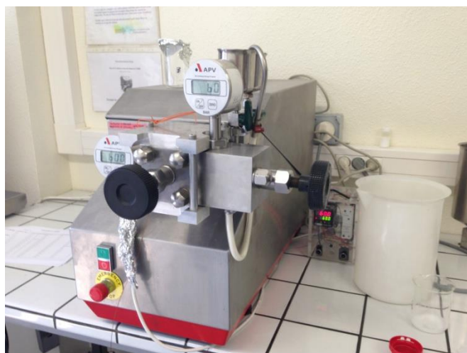
Figure 26 : Homogénéisateur haute pression à chaud utilisé au laboratoire.
