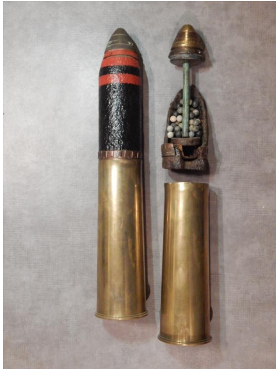
Figure n°13: Les différentes parties d'un obus à shrapnells. Collection personnelle©.
