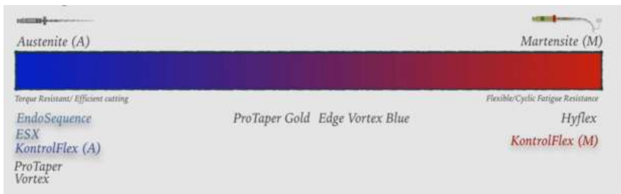
Figure 11 : Diagramme de transition de phase selon les deux types de configuration cristalline dans un alliage en NiTi (source : https://www.realworldendo.com )
