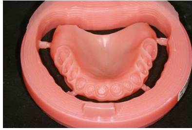
Figure 4-15 : La base prothétique est usinée dans un disque préfabriqué de PMMA. L'extrados est préparé de façon à monter les dents prothétiques dans un second temps.
