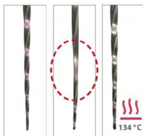
Figure 20 : Le système Hyflex CM® et l'effet mémoire de forme après stérilisation (source : http://www.infowebdental.com/dental/uploads/cp/4720303804ddf5b9b3ecd4.JPG )
