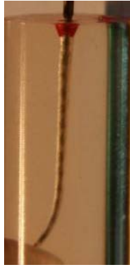
Figure 72 : Photo finale du test de la lime 25/100 e de millimètre, en CuAlBe
