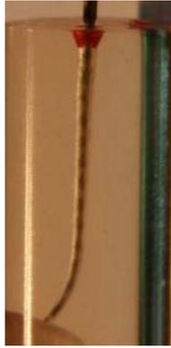
Figure 72 : Photo finale du test de la lime 25/100<sup>e</sup> de millimètre, en CuAlBe
