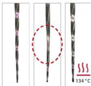
Figure 20 : Le système Hyflex CM® et l'effet mémoire de forme après stérilisation
