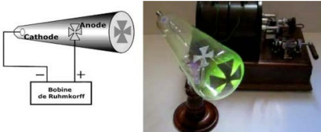
Figure 3 : Tube de Crookes alimenté par une bobine de Ruhmkorff [42]
