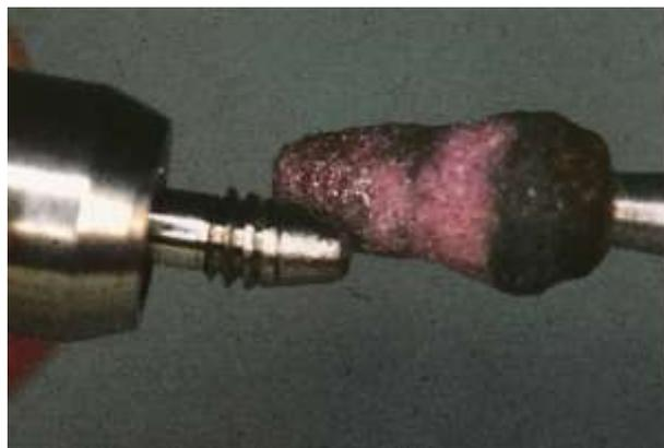
**Figure 14:** Fabrication d'un taraud
