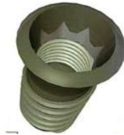
Figure 37 : Connexion à cône morse indexé
