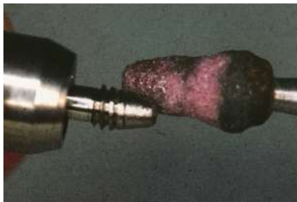
Figure 14: Fabrication d'un taraud
