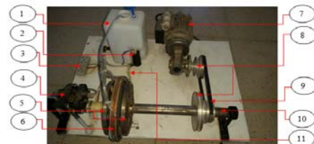
Figure 2 : La machine réalisée (1-Réservoir d'azote 2-Pompe 3- Alimentation des deux semi-induits 4- Système bagues-balais 5- Induit 6- Inducteur 7- Moteur d'entraînement 8- Réducteurs 9- Courroies 10- Axe de rotation 11- Alimentation de l'inducteur)
