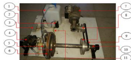
Figure 2 : La machine réalisée (1-Réservoir d'azote 2-Pompe 3- Alimentation des deux semi-induits 4- Système bagues-balais 5- Induit 6- Inducteur 7- Moteur d'entraînement 8- Réducteurs 9- Courroies 10- Axe de rotation 11- Alimentation de l'inducteur)
