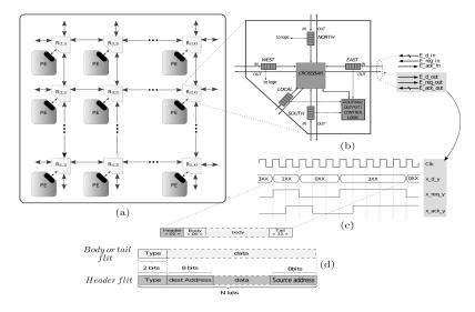
Fig. 1. (a) Structure of a 2D Mesh NoC. (b) NoC router architecture. (c) Alternate Bit Protocol. (d) Message structure
