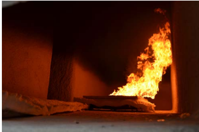
Fig. IV.4 — Photographie de la pièce lors d'un essai feu : heptane en feu
