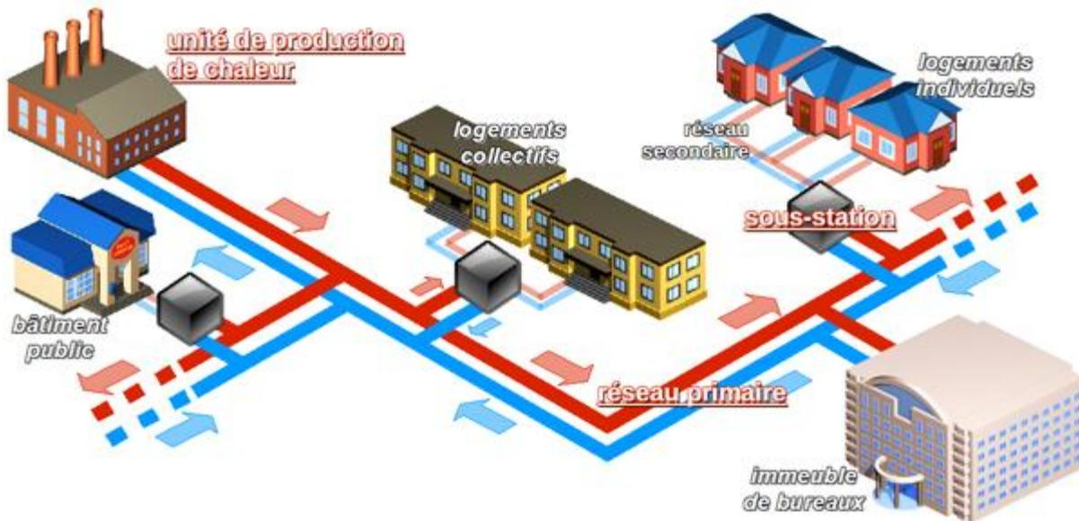
*Figure 6 : Schéma global d'un réseau de chaleur*
