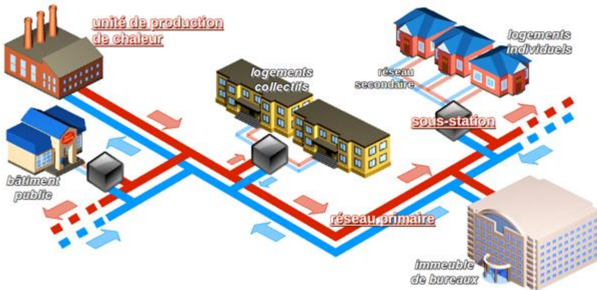
Figure 6 : Schéma global d'un réseau de chaleur
