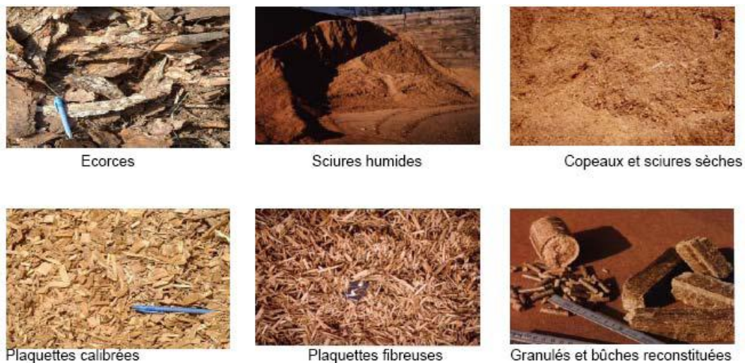
Figure 30 : Différents types de combustibles bois utilisés dans les chaudières
