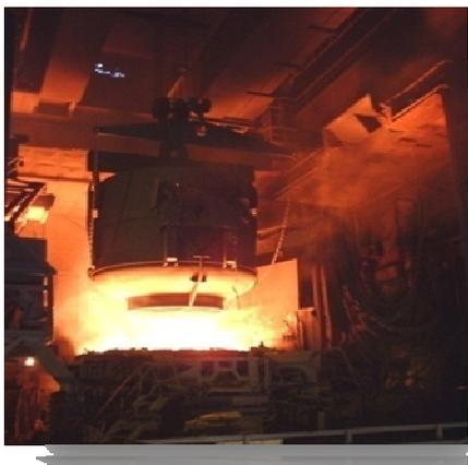
Deux paniers de 60 et 40T sont chargés à intervalle régulier au dessus du four à l'aide d'un pont radio commandé de 120 T.
