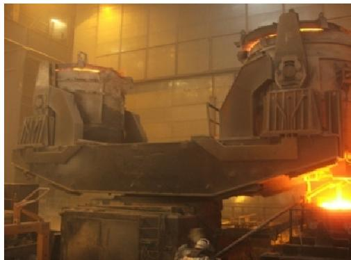
Lorsque la poche sort de l'APC, celle-ci est envoyée à la coulée continue sur le pivoteur par l'intermédiaire d'un chariot et du pont 125 T.
