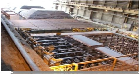
Les billettes sont ensuite « ripées » vers une zone de refroidissement. Lorsque la température des billettes est aux alentours de 600°, deux ponts à électro-aimant les stockent dans le fond du hall de la coulée continue avant d’être expédiées.
