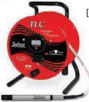
[15]<br>2-Mesures du niveau d'eau à l'aide d'un profondimètre ;                                     |
