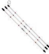
[16]<br>3-Réalisation d'un constat organoleptique des eaux via un tube préleveur à usage unique (Annexe 4) ;                |
