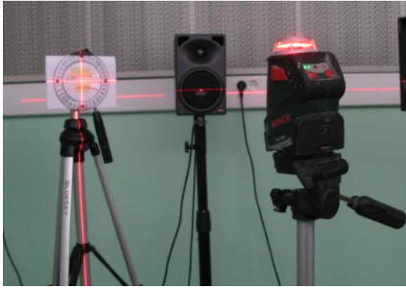
Figures 88 : Fixation du rapporteur à l'horizontal
