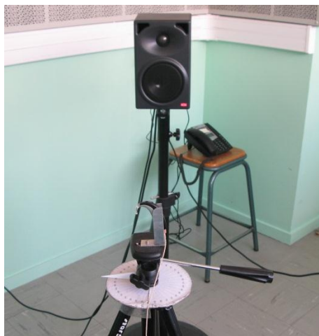
Figure 58 : Positionnement de l'aide auditive à 90° par rapport au haut-parleur
