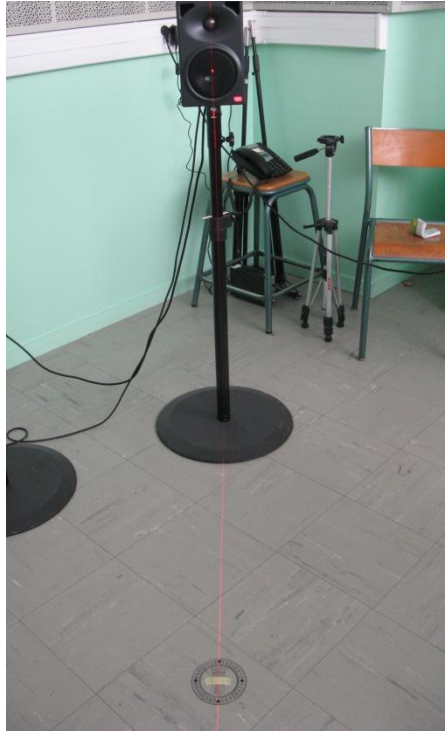
Figure 103 : Placement du rapporteur dans l'axe du haut-parleur
