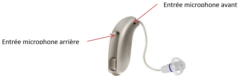
Figure 48 : Entrées microphoniques sur un Agil pro mini rite d'Oticon [39]
