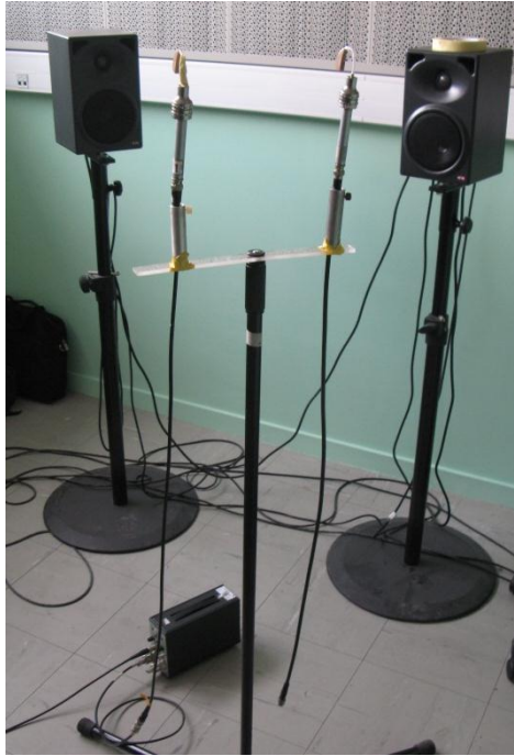
Figure 123 : Mise en place du support des deux aides auditives
