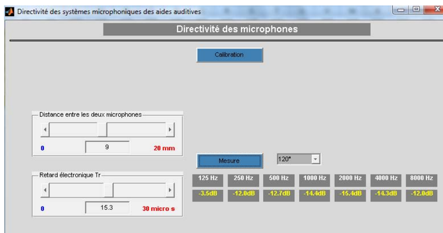
Figure 61 : Atténuation obtenue pour une directivité supercardioïde à un angle de 120^\circ
