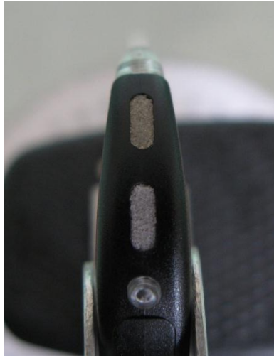
Figure 77 : Mise en place du filtre avant usagé
