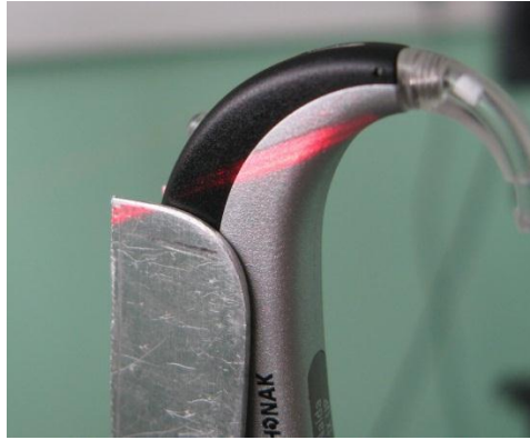
Figure 90 : Inclinaison de l'appareil à l'aide du laser
