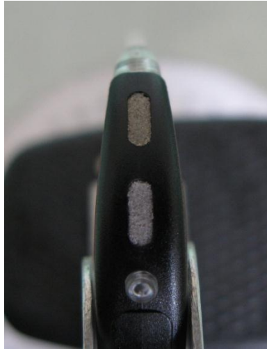
Figure 77 : Mise en place du filtre avant usagé
