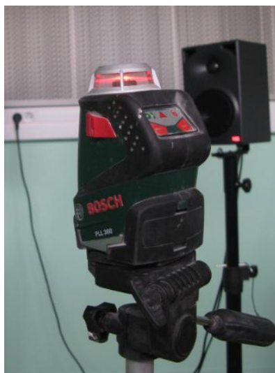
Figure 57 : Laser Bosch PLL 360 avec mise à niveau automatique
