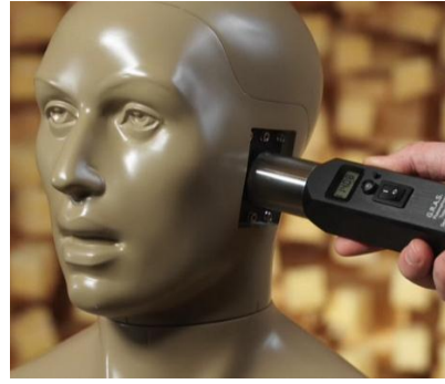
Figure 8 : Calibration du simulateur d'oreille
