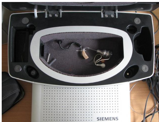
Figure 120 : Mise en place de l'Ambra microM dans la chaîne de mesure
